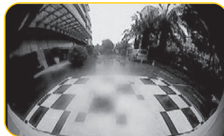
روی دوربین جلو آب وجود دارد
