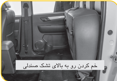
تسمه نواری اتصال دهنده صندلی های عقب
