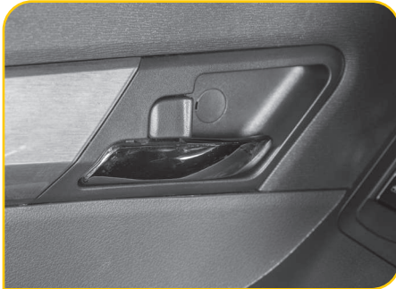
(پس از کشیدن دستگیره داخلی درب، قفل درب خودش با استفاده از دستگیره داخلی باز می‌شود)
